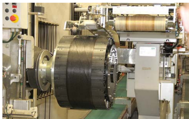
Аппарат накручивает на заготовку бегового слоя бесшовный нейлоновый бандаж
