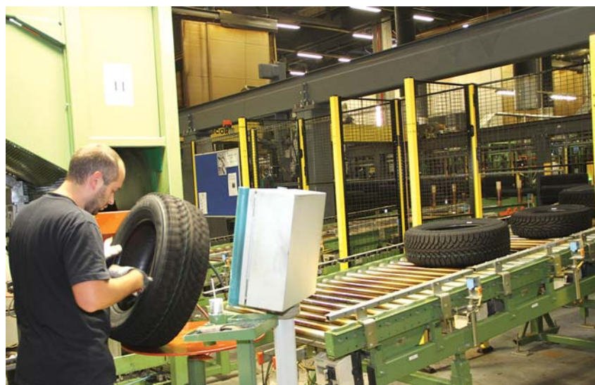
После наварки протектора шину подвергают визуальному осмотру. Далее она отправляется на склад для хранения.
