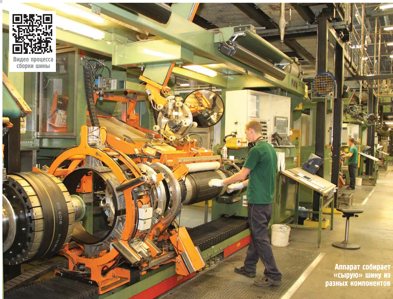
Аппарат накручивает на заготовку бегового слоя бесшовный нейлоновый бандаж
