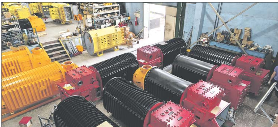
ШЗГШО создает энергопоезда - высокотехнологичные взрывобезопасные подстанции.
