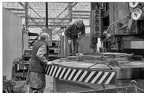
На карусельном станке производят детали для АЭС.
