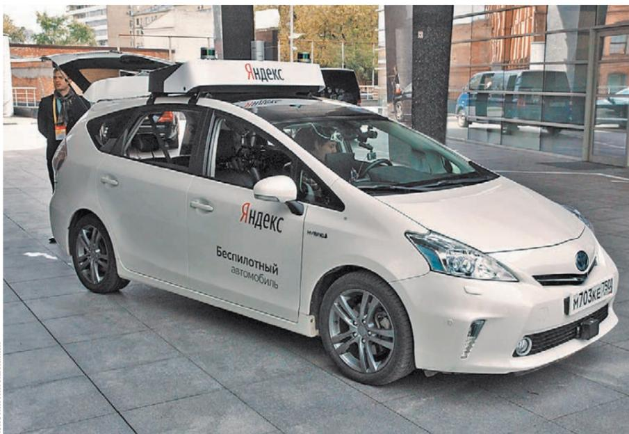
В данный момент беспилотники Яндекс, собранные на базе серийных автомобилей, проходят испытания на закрытых площадках.
